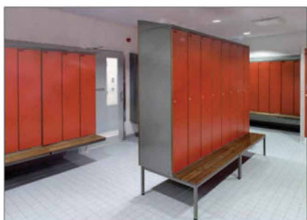
VKP skabe med skråt tag, PP understel med bænke. Ståldøre i 19 mm sandwich konstruktion med forstærkning og lyddæmpning. Abloy CL 103C-lås.
